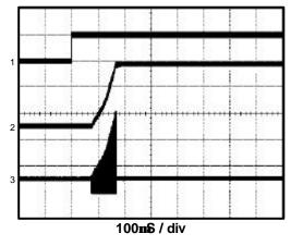
1)  $V_{EN} = 2V / div$ 2)  $V_{SW}$ , 10V / div 3)  $V_{OUT}$ , 10V / div
